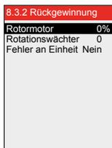
Falls keine Störung am Rotormotor vorliegt (Nein bei "Störung an Einheit"), kann ein Zwangsstart aktiviert werden.
