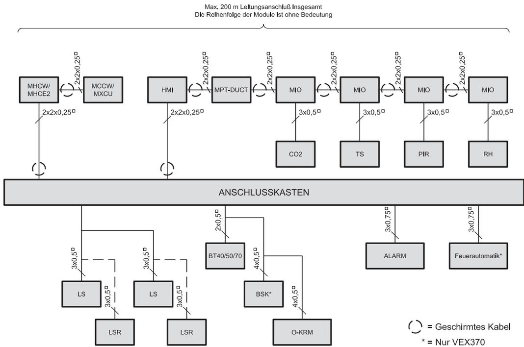
\* Spannungsversorgung 1x230V(50Hz), sowie die einzelnen Kabel zu den Brandschutzklappen sind in diesem Kabelplan nicht berücksichtigt.
