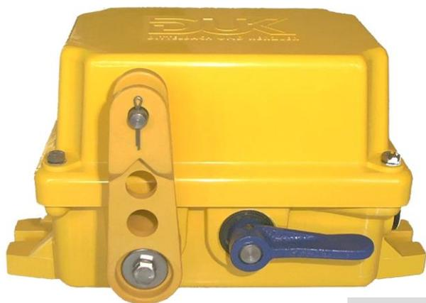
Durch die Ausstattung mit zwei Spannfedern unseres Types SPF-W wird die Forderung der EN 60947-5-5 (automatischer Not-Halt Befehl bei Seilriss) erfüllt.
